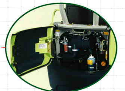
メンテナンスがしやすい 大きな開口のボンネット
